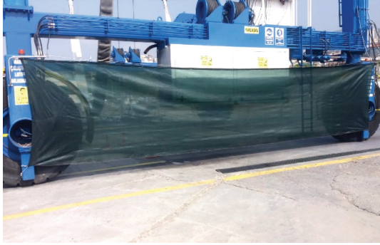
Tekne Yıkamalarında Koruyucu Perde Kullanımı (Kuşadası Setur Marina)
