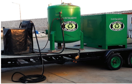
Çevre-Dostu Aşındırıcı Püskürtme (Soda) Uygulaması (Mersin Marina)
