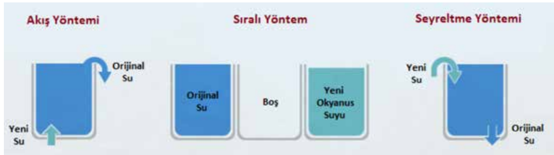
Şekil 7. Balast Suyu Değiştirme Yöntemleri
