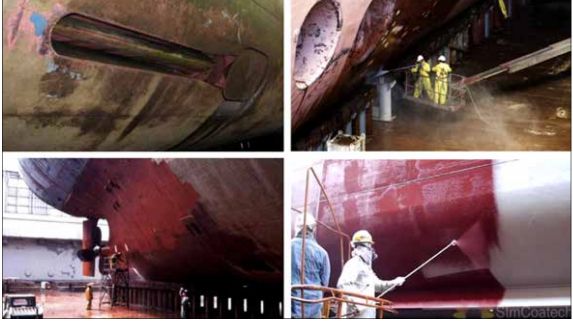
Şekil 16. Gemi Gövde Temizliği ve Biyolojik Kirlilik Önleyici Sistemin Yenilenmesi
